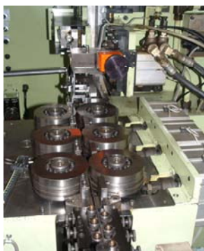
Rys. 1. Fotografia urządzenia do zwijania pierścieni z taśmy stalowej Fig.1. View of device to rolling up from steel tape the rings
