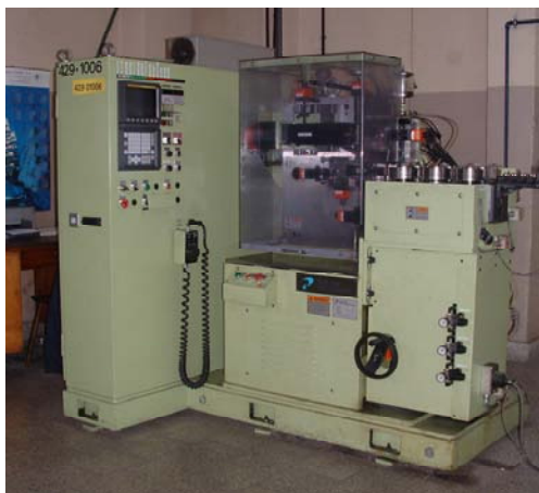
Rys. 1. Fotografia urządzenia do zwijania pierścieni z taśmy stalowej Fig.1. View of device to rolling up from steel tape the rings
